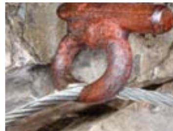
Abb. 2 Durch Zugbelastung am Drahtseil eingesägter Ösenanker
