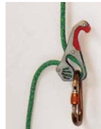
Ähnlich beim Ablassen, wo beide Hände das Bremsseil umfassen. Der Daumen der oberen Hand stellt das Gerät horizontal, und je nach Neigungswinkel und Bremshandwirkung wird die Ablassgeschwindigkeit kontrolliert.
