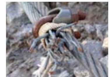
Abb. 4 Beschädigungen am Klettersteig sind beim Aufstieg von unten leider oft nicht zu erkennen
