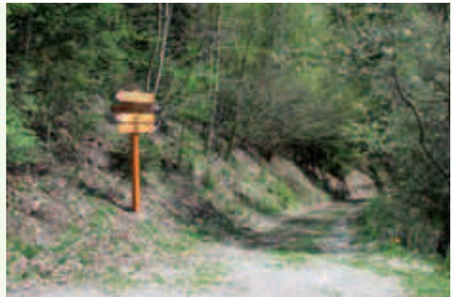
Sind am gleichen Ort mehrere Routen in verschiedene Richtungen zu markieren, so sind die Wegweiser an geeigneter Stelle zusammenzufassen.
